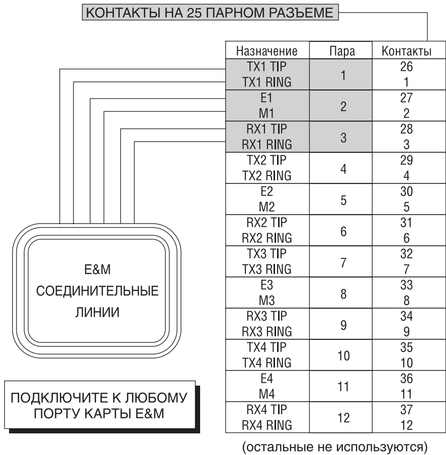
Рис. 5-3 Подключение соединительных линий E&M
