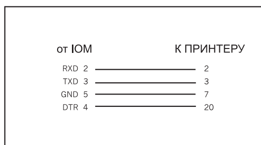
Рис. 7-5 Распайка кабеля для подключения принтера
