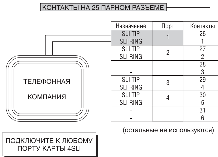
Рис. 5-4 Подключение линий OPX к карте SLI
